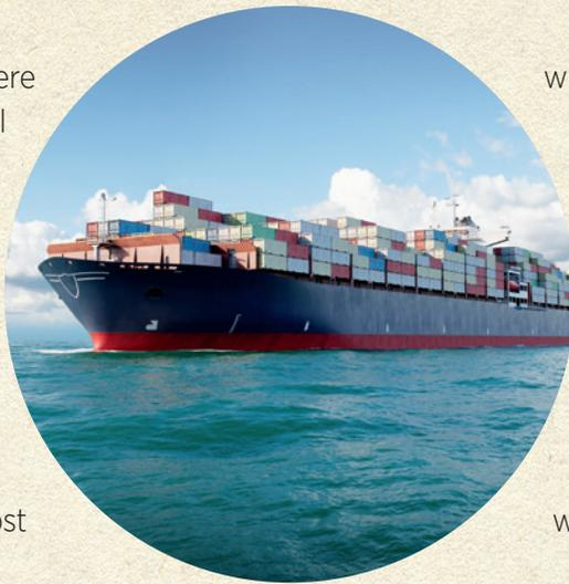
wiegt. Wenn es zum Beispiel 5.000 Tonnen wiegt, verdrängt es 5.000 Tonnen Wasser. Das Wasser drückt von unten gegen den Rumpf – das nennt man Auftrieb. Er ist stark genug, um das schwere Schiff zu tragen. Das funktioniert, wenn ein Gegenstand eine geringere Dichte hat als Wasser – oder wenn er große Hohlräume mit Luft enthält wie die meisten Schiffe. Deshalb musst du dir keine Sorgen machen, wenn du mit einem Schiff fährst.
